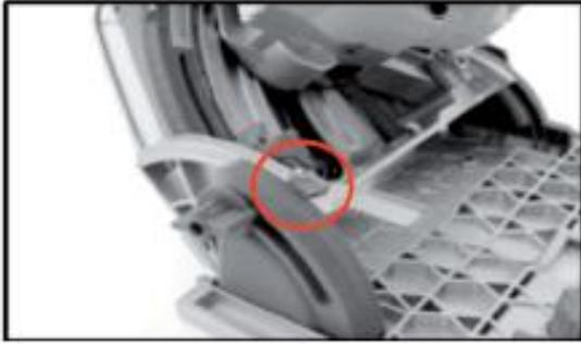
1. Incline la sierra de incisión a la posición de 45° para ajustar la flecha a 45° (véase el círculo)
